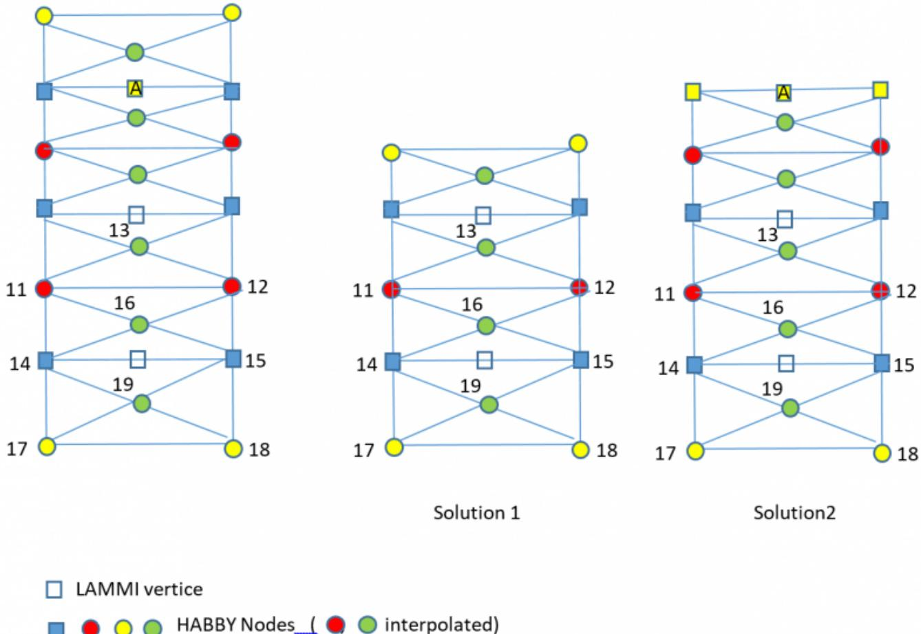
La figure ci dessus schématise le cas particulier d'un maillage avec une verticale LAMMI de hauteur d'eau nulle  $H_A=0$ , deux solutions sont possibles et c'est la solution 2 qui est retenue par HABBY.
