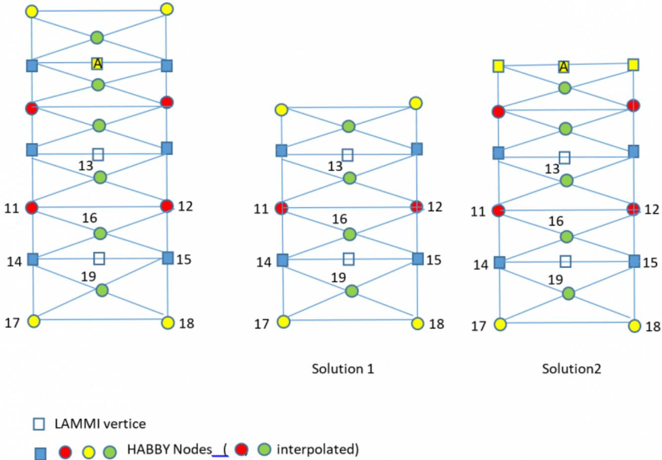
La figure ci dessus schématise le cas particulier d'un maillage avec une verticale LAMMI de hauteur d'eau nulle  $H_A=0$ , deux solutions sont possibles et c'est la solution 2 qui est retenue par HABBY dans le cas d'un choix éléments finis.
