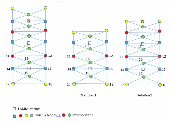
La figure ci dessus schématise le cas particulier d'un maillage avec une verticale LAMMI de hauteur d'eau nulle  $\mathcal{H}_{A}=0$ , deux solutions sont possibles et c'est la solution 2 qui est retenue par HABBY dans le cas d'un choix éléments finis.
