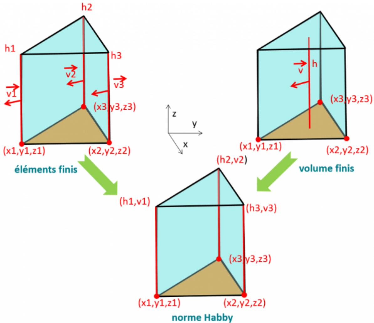
Notons aussi que les maillages d'origines des modèles hydrauliques 2D ne sont pas nécessairement triangulaires dans le plan, il peuvent être constitués de polygones plus ou moins complexes et ne comportant pas systématiquement le même nombres de côtés. Dans tous les cas HABBY les transformera dans son format unique.
