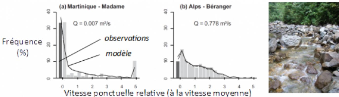
Exemples de modèles hydrauliques statistiques (Girard et al. 2014) pour prédire des distributions de vitesse dans les tronçons de cours d'eau de différentes rivières. L'approche est particulièrement pertinente en écoulements très complexes (tropicaux, montagnes). Les variables d'entrée des modèles statistiques sont simples à mesurer, ce qui facilite leur utilisation pour les études à l'échelle des tronçons ... ainsi qu'à l'échelle des bassins versants.
