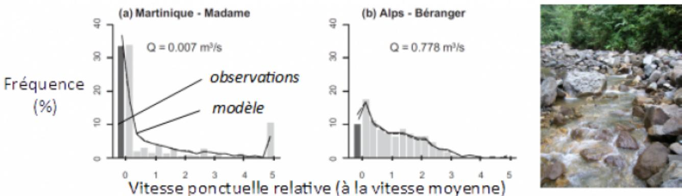
Exemples de modèles hydrauliques statistiques (Girard et al. 2014) pour prédire des distributions de vitesse dans les tronçons de cours d'eau de différentes rivières. L'approche est particulièrement pertinente en écoulements très complexes (tropiques, montagnes). Les variables d'entrée des modèles statistiques sont simples à mesurer, ce qui facilite leur utilisation pour les études à l'échelle des tronçons ... ainsi qu'à l'échelle des bassins versants.
